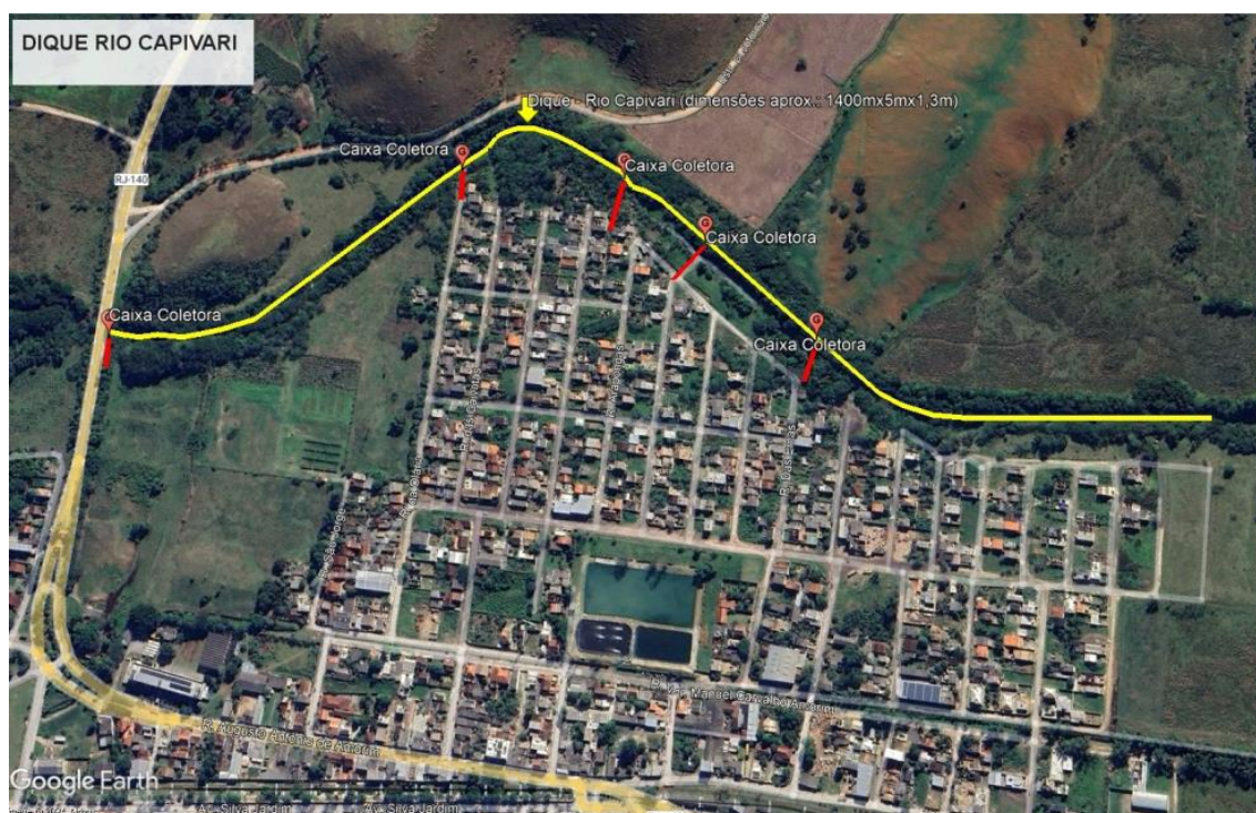
Figura 39 - Extensão do Dique do Rio Capivari e suas respectivas caixas coletoras.
